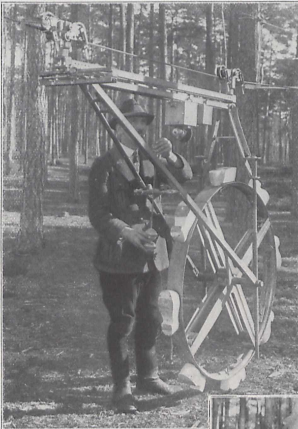
Fig. 1 (links). Das Fährtenrad mit Porzellanfüßen, durch das eine künstliche mens- chliche Spur her- gestellt wird.
