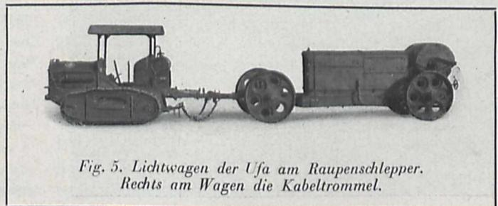
Fig. 5. Lichtwagen der Ufa am Raupenschlepper. Rechts am Wagen die Kabeltrommel.
