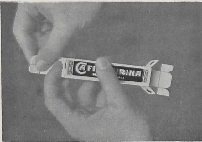
Fig. 15. Schachtel mit Einsteckklappe, an der besondere Sicherheitsflügel angeschnitten sind.
