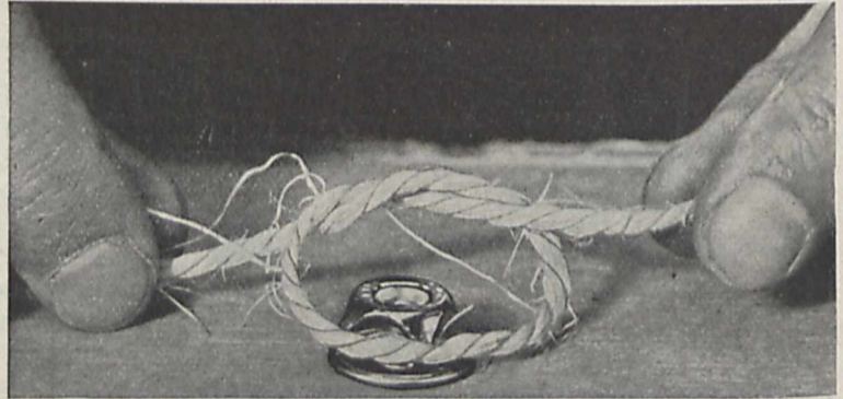
Fig. 9. Wie der Bindfaden an der Wickelplombe befestigt wird. (Fa. Fritz Killing, Köln.)
