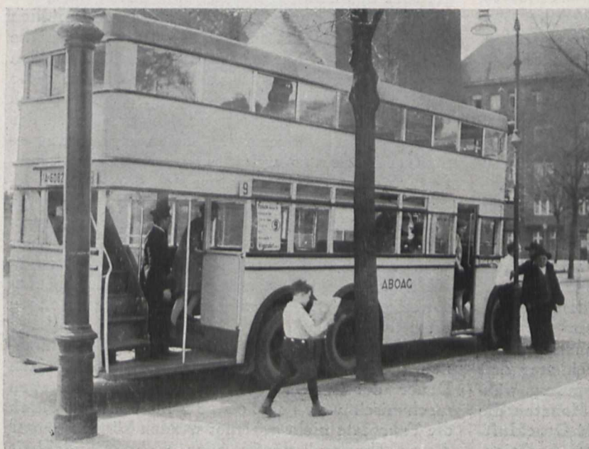
Fig. 4. Berliner Omnibus, dessen Vordertür sich selbsttätig öffnet und schließt.
