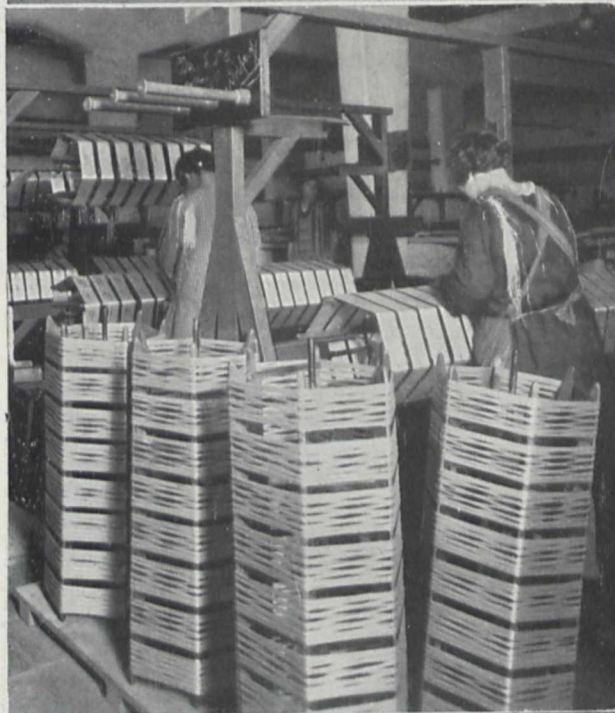
Fig. 11. Von den Zwirnspulen gleitet der Faden auf Haspelmaschinen, wo er zu Strängen aufgespelt wird.
