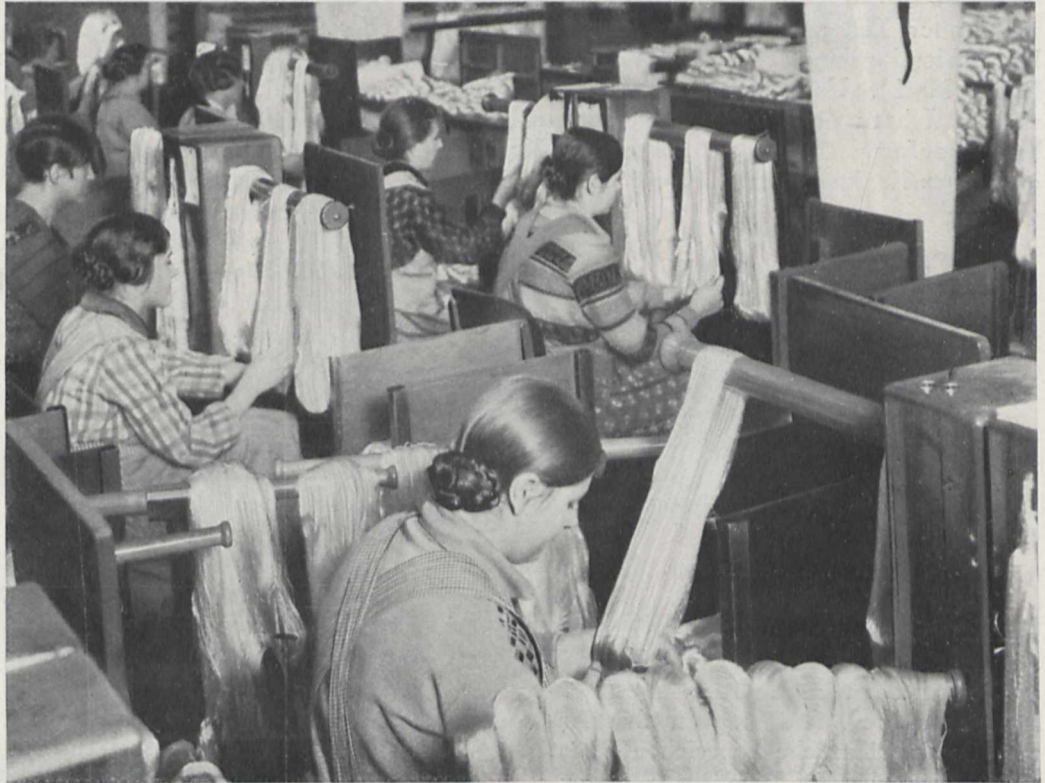
Fig. 13. Vor dem Versand wird in der Sortiererei der Seidenfaden noch einmal sorgfältig geprüft.
