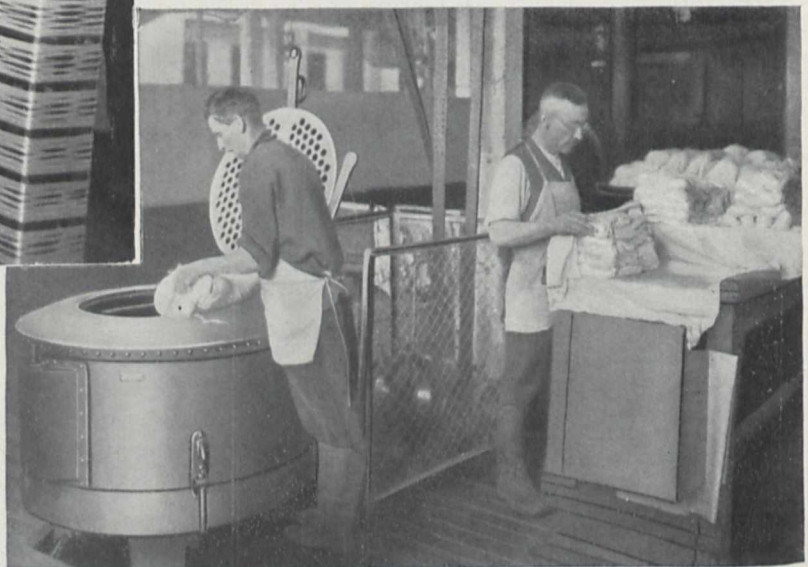
Fig. 12. Die nachbehandelte Seide wird zentrifugiert, statt verzwirnt.
