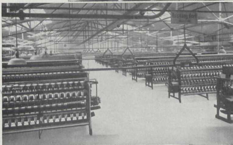
Fig. 11. Von den Zwirnspulen gleitet der Faden auf Haspelmaschinen, wo er zu Strängen aufgespelt wird.
