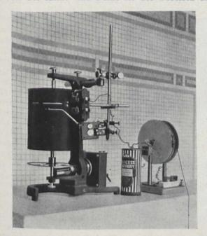
Fig. 5. Die Schreibtrommel des Natographen.
