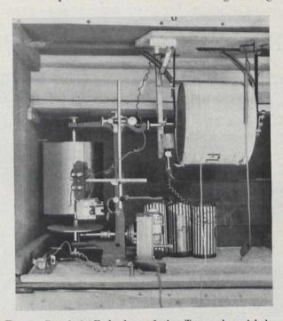
Fig. 6. Das freie Ende der auf eine Trommel gewickelten Leine wird dem Schwimmer um die Brust gelegt. Beim Schwimmen wird die Trommel in Umdrehung versetzt und betätigt die Schreibvorrichtung des Natographen.
