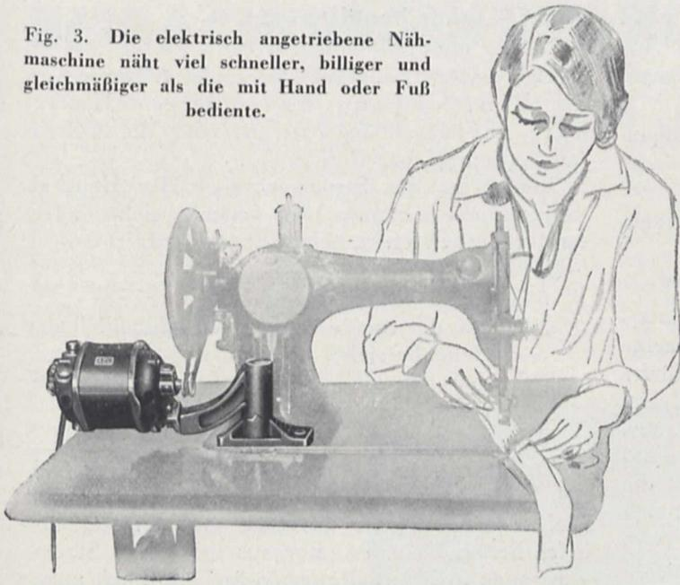
für alles“ geworden. Je nach Bedarf treibt er Melkmaschinen, Milch- und Butterzentrifugen, Futterschneider, Windfegen, Trieure usw. an, durch Aufstecken einer biegsamen Welle läßt er sich zum Antrieb von Schermaschinen, Putzbürsten, Schleifvorrichtungen usw. verwenden, — überall im Betriebe, wo er benötigt wird, kann dieser kleine, tragbare Landwirtschaftsmotor eingespannt werden.
