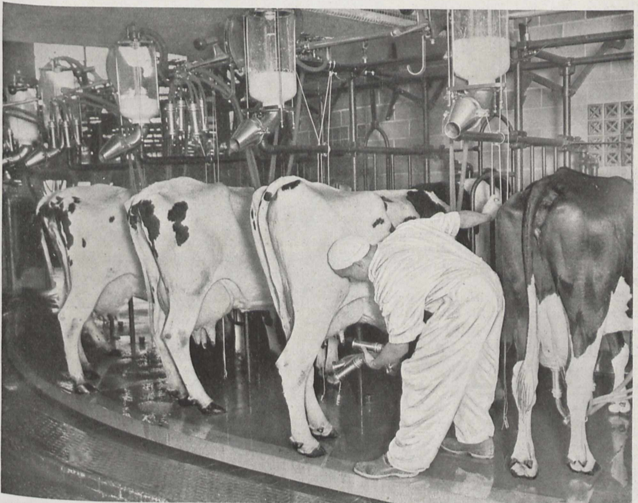
Fig. 5. Ehe eine Kuh die Drehscheibe verläßt, werden die Milchsauger abgenommen und so aufgehängt, daß sie automatisch gewaschen und sterilisiert werden, ehe sie bei einer anderen Kuh wieder angesetzt werden
