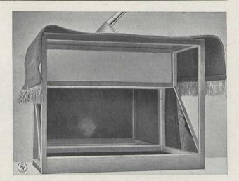
Fig. 4. Das Versuchsgerät gestattet Beobachtung des Teppichs von unten während des Saugens Im Spiegelbild sieht man eine absichtlich unter den Teppich gebrachte Staubmenge
