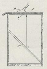
Fig. 3. Versuchsgerät für Staubsaugeruntersuchung a = Spiegel, b = Glasplatte, c = Teppich, d = Düse
