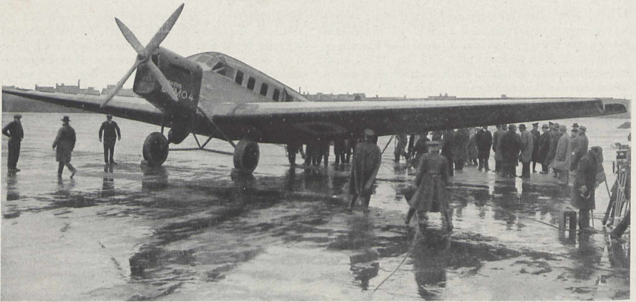
Fig. 6. Auf dem Tempelhofer Feld bei Berlin startete das erste, mit einem Schwerölmotor ausgestattete Flugzeug der Welt, die Junkers-Maschine „Jumo 4“.
