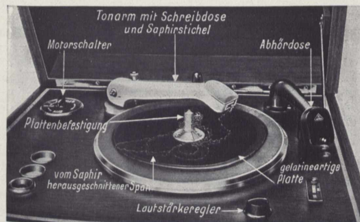
Fig. 9. Der Tonschreiber schneidet aus einer gelatineartigen Folie einen haarfeinen Faden heraus, der sich am Achsstummel aufwickelt
