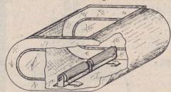
und kränklichen Personen ist der Zugriff zu den Füßen im Fußbad durch "Rudli" leicht gemacht. Der Apparat, 25 cm breit, besteht aus einem verzinkten Eisengestell, auf welchem zwei herausnehmbare, drehbare, starke, gerippte Para-Gummiwalzen laufen. Die Füße werden an den Walzen einfach hin und her gestreift.
