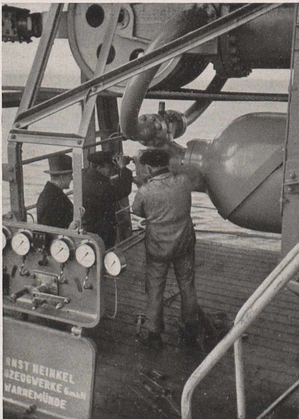
Fig. 2. Die hydraulische Startvorrichtung des Heinkel-Katapults ermöglicht den gefahrlosen Start des Flugzeuges von der schwimmenden Insel.
