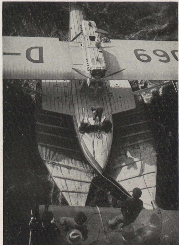
Fig. 5. Das Flugboot ist auf dem Stausegel gelandet.
