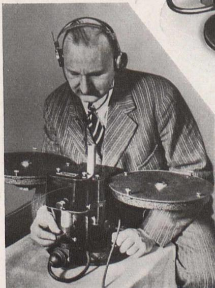
Fig. 3. Tonphotograph-Aufnahme mit Tageslichtfilm. Kontrolle des Tons durch Kopfhörer und der Tonaufzeichnung durch das Visierrohr
