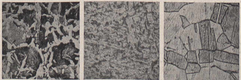
Fig. 1. Kohlenstoff-Stahl Fig. 2. 14%iger Chrom-Stahl Fig. 3. 18/8-Chrom-Nickel-Stahl Normal-Gefüge von gewöhnlichem Kohlenstoffstahl, rostfreiem Chrom- und weitgehend säurebeständigem Chrom-Nickel-Stahl.
