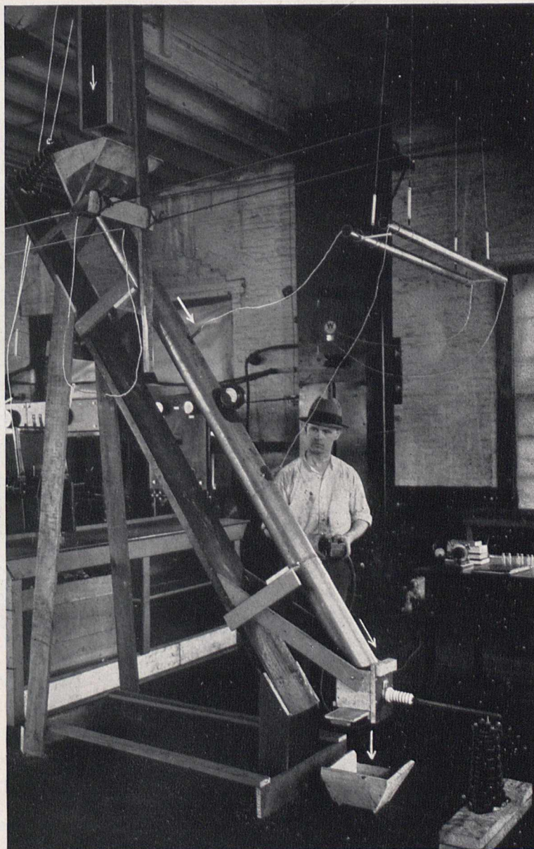
Fig. 3. Durch die Kupferröhre fließt das Getreide (in der Pfeilrichtung), das von Schädlingen befreit werden soll, an einem elektrischen Kurzwellen-Kraftfeld vorbei
