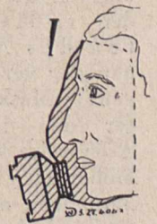
Fig. 1. Totraum der Gasmasken (schraffiert)
