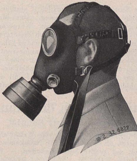
Fig. 3. Maske mit Zweiwegeatmung. Die ausgeatmete Luft geht durch ein Ventil direkt ins Freie. Besonders bei Nebelfiltereinsätzen benutzt. Fig. 1 bis 5 verdanken wir den Drägerwerken, Lübeck.
