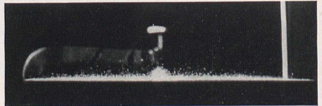
Fig. 12. Schwingende Platte, von der Seite gesehen. Man erkennt, wie heftig der aufgestreute Sand hochgeschleudert wird
