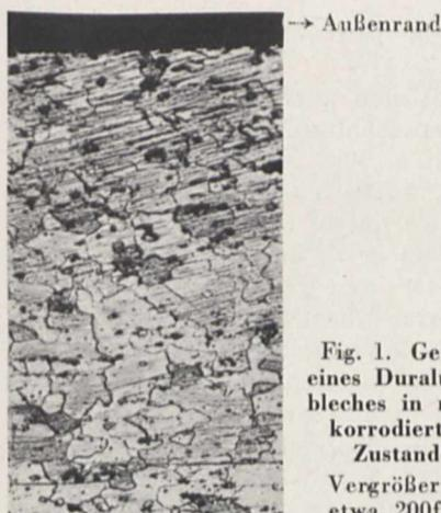
Fig. 1. Gefüge eines Duraluminbleches in nicht-korrodierendem Zustande
