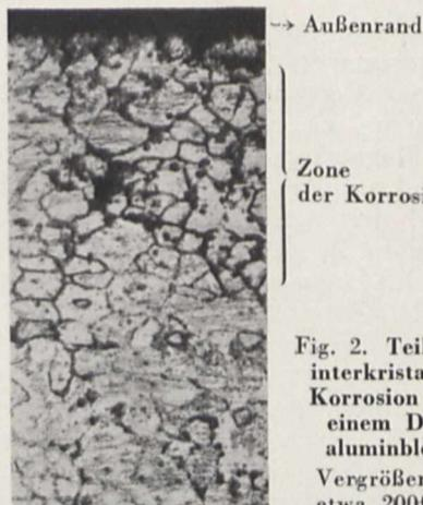
Fig. 2. Teilweise interkristalline Korrosion an einem Duraluminblech
