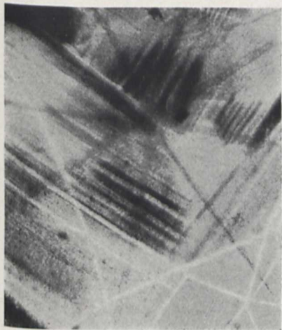
Fig. 1. Natürlicher Rubin mit Rutilnadeln, die, zu Büscheln zusammengelagert, zonare Struktur zeigen. Vergr. 40fach
