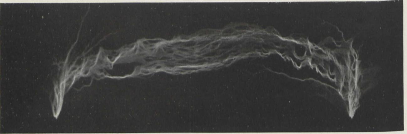
Fig. 1. Ueberschlag einer 4,5 Meter langen Luftstrecke bei einer Spannung von 2,2 Millionen Volt.
