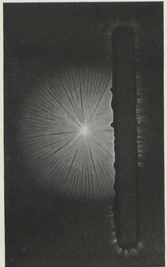
Fig. 3. Negative Gleitfigur in Luft, bei einem Spannungsstoß, 45 000 Volt.
