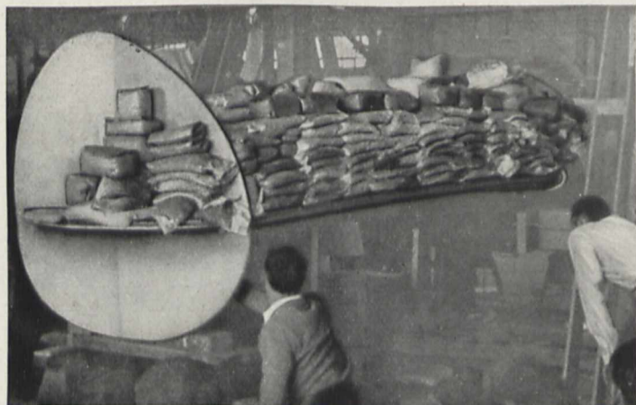
Bild 6. Die Schwanzflächen werden einer besonderen Belastungsprobe unterworfen
