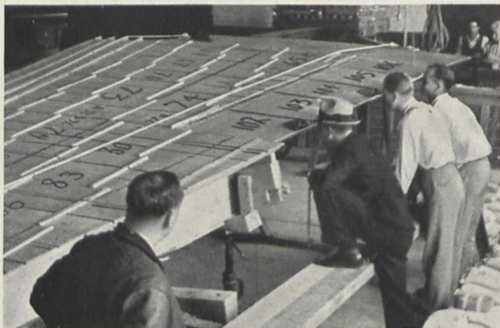
Bild 4. Durch Gucklöcher kann man während der Belastungsproben in das elektrisch erleuchtete Flügelinnere sehen
