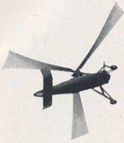
Bild 1. Autogiro im Fluge über Versailles. Die schmalen Blätter werden wohl vom Photoapparat mit \frac{1}{60} Sek. festgehalten; für den Insassen sind sie kaum bemerkbar. Man sitzt ganz frei ohne Beschränkung der Sicht.
