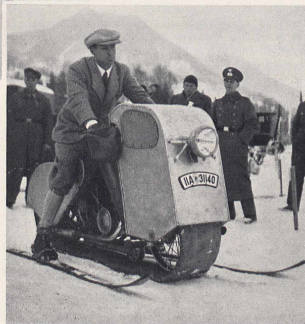
Bild 2. Zur Ausrüstung des einspurigen „Gleitketten-Kraftfahrzeuges“ gehört auch ein Paar Ski für den Fahrer
