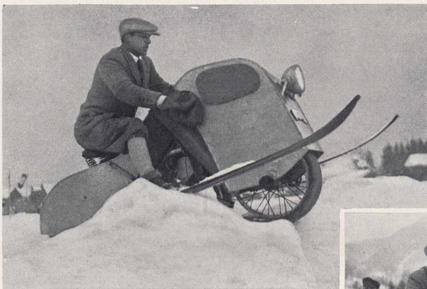
Bild 1. Ein Raupen-Motorrad, das bei den diesjährigen Kraftfahrzeug-Winterprüfungen vom Erfinder, Ing. Dr. F. Riemerschmidt, vorgeführt wurde, soll sich besonders für schwer befahrbare Gelände eignen. Das Bild zeigt das Motorrad beim Fahren über ein unebenes Schneefeld.
