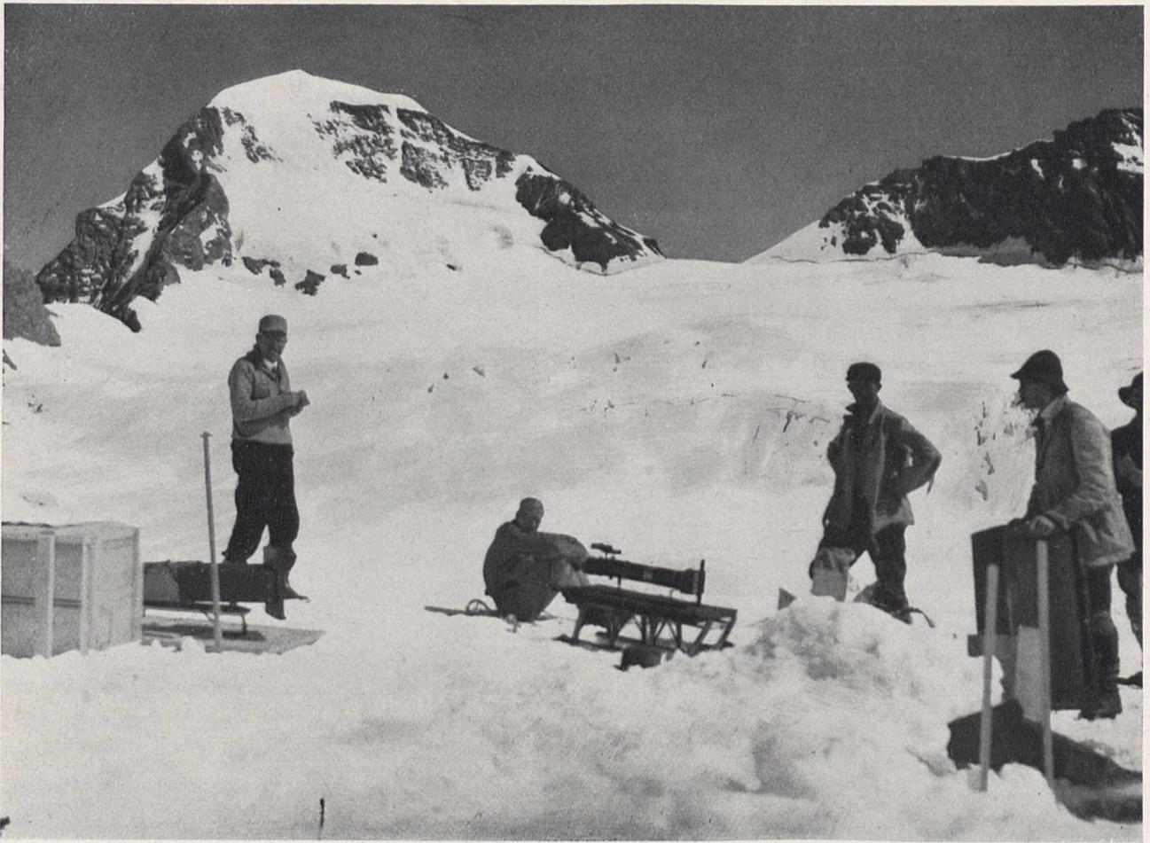
Bild 5. Messung des bodennahen Ozons über dem Jungfraufirn
