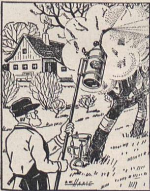
Trichters oder alten Kännchens in die Spritze gefüllt. Die Spritze sollte nur bis zum Falz des Behälters gefüllt werden. Nach dem Schließen der Spritze wird mit der Fahrradpumpe so lange Luft eingepumpt, bis sich ein starker Widerstand bemerkbar macht. Die Spritze ist jetzt betriebsfertig und bewirkt beim Öffnen des Ventils eine sehr feine Versprühung der Spritzbrühe.
