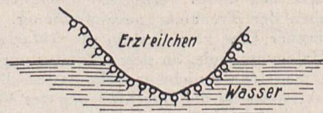
Bild 3. Erzteilchen mit teilweisem Ueberzug von Sammlermolekülen  $\circ$  (1 polarer Teil,  $\circ$  nichtpolarer Teil)
