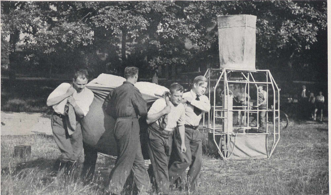
Bild 1. Aufstieg einer neuartigen Montgolfière auf dem Bornstedter Feld bei Potsdam: Die Ballonhülle wird herangebracht; rechts die Gondel, in welcher durch flüssiges Gas mit einem Brenner Heißluft erzeugt wird. Photo: Scherl-Bilderdienst
