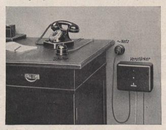
das Wechselstromnetz. Mittels einer Steckerschnur kann der Verstärker an jede normale Steckdose angeschlossen werden. Der Verstärker ist durch eine kleine Feinsicherung, die leicht zugänglich auf der Vorderfront angeordnet ist, gesichert. — Der Leistungsverbrauch ist sehr gering, er beträgt nur etwa 4 VA. Für Anschluß an Gleichstromnetze sind ähnliche Verstärker vorhanden.
