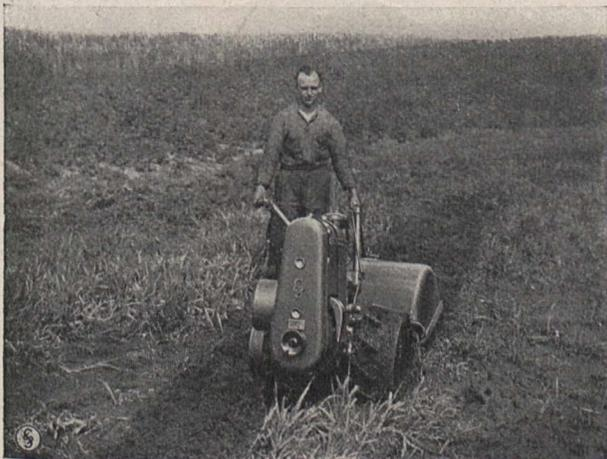
Bild 2. Die Kleinfräse beim Unterbringen von Gründünger
