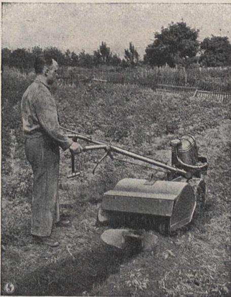
Bild 1. Kleinfräse mit Kartoffelhäufel
