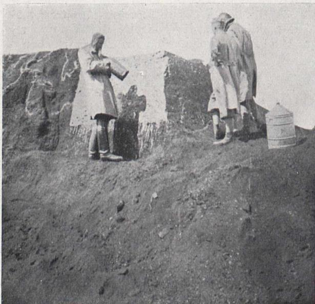
reste aus der Braunkohle auf Lack übertragen, sondern auch größere Schichtflächen und Profile durch alle möglichen lockeren Gesteine und Böden buchstäblich auf Lack ziehen kann.
