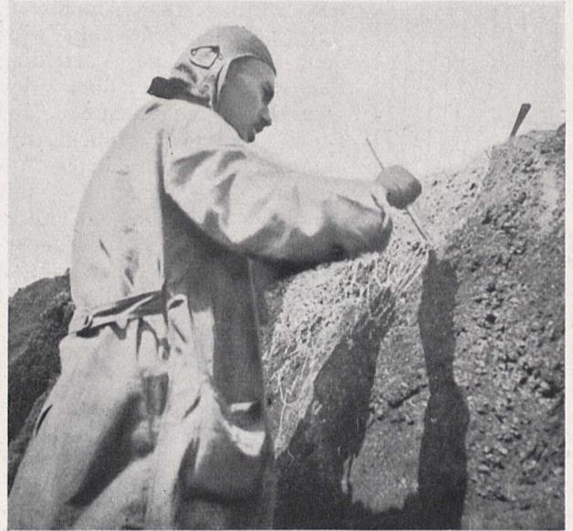
Bild 1. Einlackieren einer Wand des auf Lack zu übertragenden Block-profiles
