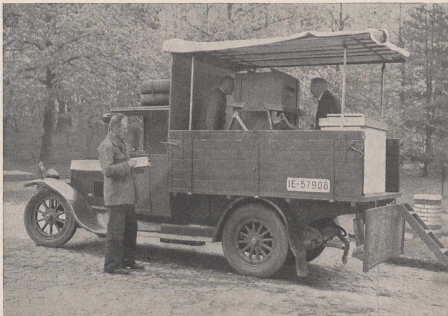
Bild 2. Messung mit dem neuen ortsbeweglichen Schweremesser im Gelände.
