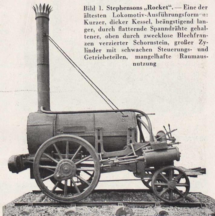
Bild 1. Stephenson's „Rocket“. — Eine der ältesten Lokomotiv-Ausführungsformen: Kurzer, dicker Kessel, beängstigend langer, durch flatternde Spanndrähte gehaltener, oben durch zwecklose Blechfransen verzierter Schornstein, großer Zylinder mit schwachen Steuerungs- und Getriebeteilen, mangelhafte Raumausnutzung
