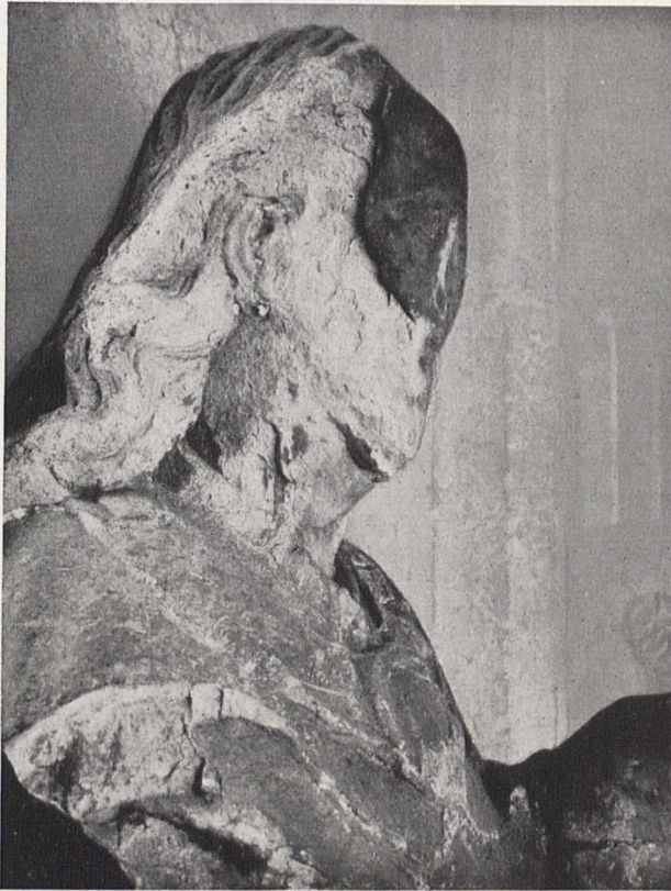
Bild 3. Durch Schalenbildung zerstörte Sandsteinplastik. Mit Ausnahme der noch lose haftenden Stirnschale ist nur noch der Gesteinskern mit daraufliegenden Resten der mehrlagenigen Zwischenschichten erhalten.
