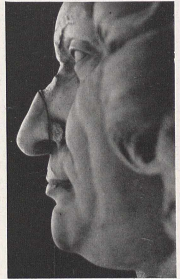
Bild 5. Verwitterungserscheinungen an Vintschgauer (Laaser) Marmor. Nasenspitze ersetzt. Photo: Dr. Orth-Lindenverlag
