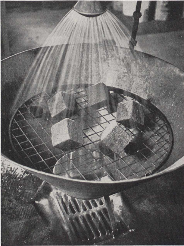
Bild 11. Imprägnierte Probewürfel werden „beregnet“
