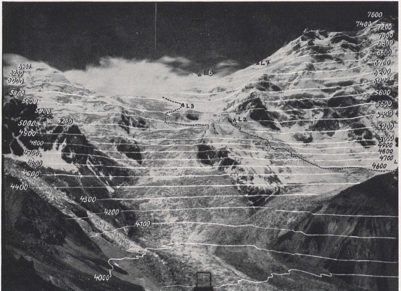
Bild 2. Oberstes Rakhiot-Tal mit Rakhiot-Gletscher. — Der Weg der Bergsteiger (punktiert) und photogrammetrische Höhenschichtlinien (weiß). — Die Lager sind mit L_2 , L_3 u. s. f. bezeichnet.
