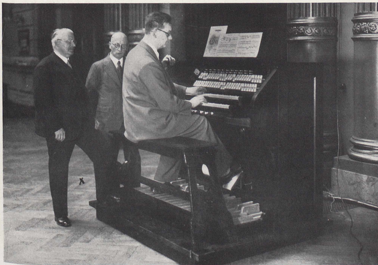
Bild 3. Die Welte-Lichtton-Organ verwendet, ähnlich dem Tonfilm, ein elektrooptisches Verfahren für die Klangerzeugung. Links vom Spieltisch: der Erbauer Edwin Welte (X) mit seinem Mitarbeiter Wilhelm Faaß
