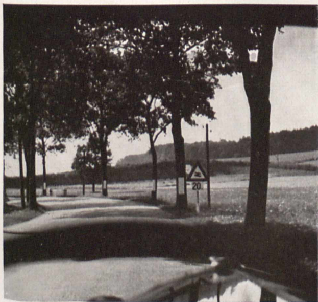
Bild 1. Kurvenzeichen und zugleich eine Entfernungsangabe in Meter Vgl. den Aufsatz auf der nächsten Seite
