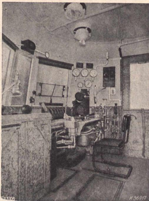
Bild 1. Führerstand der elektrischen Lokomotive
