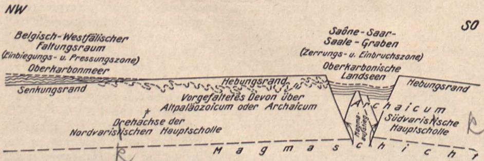
Bild 1. Schematische Darstellung der Kippbewegungen der beiden variskischen Hauptschollen und der Entstehung des Saar-Saale-Grabens
