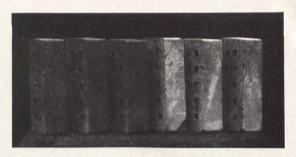
Bild 4. Ziegelsteine links mit und rechts ohne Zusatz von Bariumkarbonat
