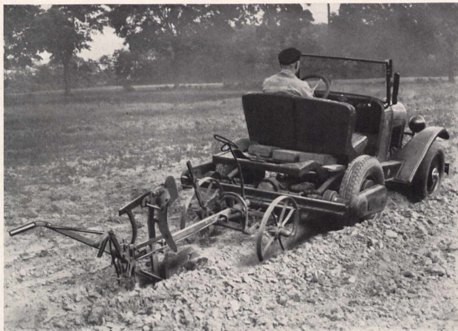
Bild 6. An einen gewöhnlichen Personenkraftwagen angebaute Schlepperachse beim Ziehen eines Pfluges. — Anbauzeit für die Schlepperachse etwa 8 Minuten
