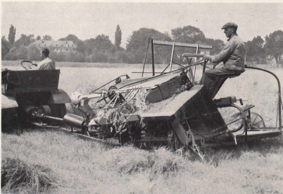
Bild 4. Klein-Raupenschlepper. — DKW-Motor (8 PS). Lenkung durch Handrad. Fahrgeschwindigkeit bis 6 km/h
