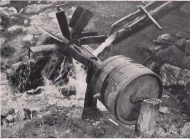
Bild 2. Die „Turbinen“-Anlage von der Abtriebsseite. Lustig dreht sich — mitgenommen durch einen einfachen Vierkantbolzen — das zur Reinigung „eingelegte“ Milchfaß. Eingefüllter Kies unterstützt den Spülvorgang. (Eine lebendige Ur-Scheuertrommel!). Die schöne Form der Rad-Welle ist auf dem Bild besonders gut zu sehen
