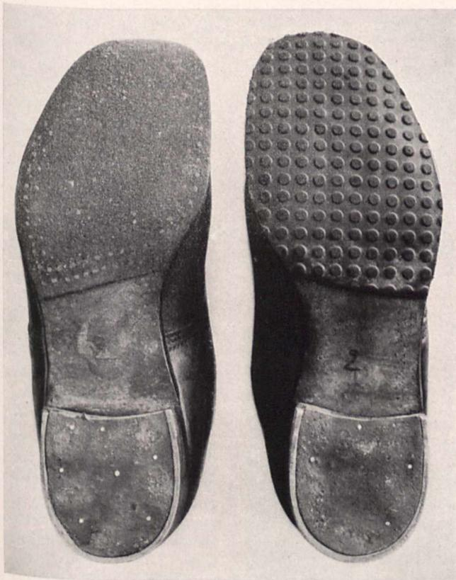
Bild 2. Bei den Versuchen verwendete hohe Schuhe (Arbeitsschuhe); links mit Ledersohle, rechts mit Nockengummisohle
