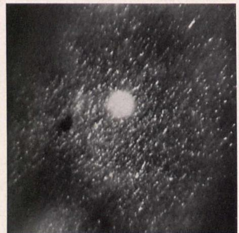
Bild 8. Elektronenbild eines Ultrafilters. — Um größere Bakterien oder andere Teilchen von kleinsten Bakterien oder Viren zu erkennen, nimmt man Filter von Kollodium oder ähnlichen Stoffen. Das Elektronenbild zeigte erstmalig die Poren dieser Filter, welche die großen Bestandteile zurückhalten, die kleinen passieren lassen. Auch Fehler im Filter können nun festgestellt werden
