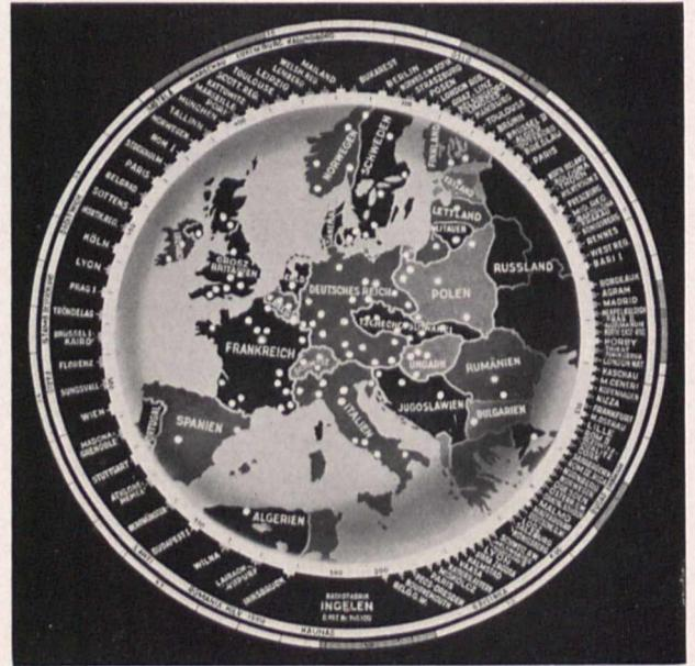
Bild 4. Geographische Stationsmeldung an einem 5-Rohr-Super. Während der Leuchtzeiger den jeweils eingestellten Stationsnamen am Skalenrand erhellt, leuchtet auf der auf Glas aufgetragenen Landkarte Europas der Standort des betreffenden Senders auf
