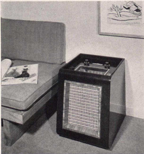
Bild 3. Der Sessel-Super, die Sonderausführung eines Groß-Supers, die insbesondere ausländischen Geschmacksrichtungen entgegenkommt. Das Gerät ist fahrbar, Skala und Bedienungsknöpfe liegen oben, so daß sie „vom Sessel aus“ bedient werden können. Eine lange Netzschur verbindet den Empfänger mit dem Netz, das auch als Netzantenne benutzt wird
