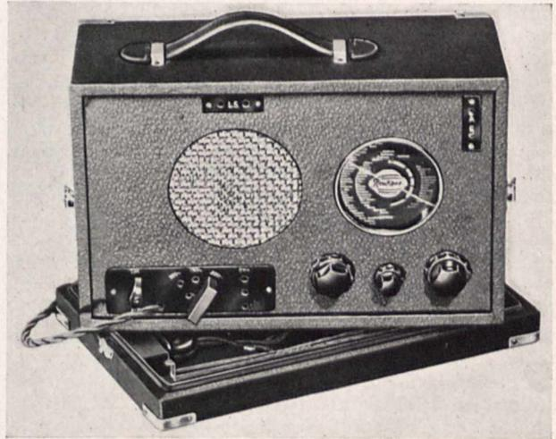
Bild 6. Neuer Auto- und Reiseempfänger, ein Vierröhren-Super für drei Wellenbereiche, der an eine Autobatterie sowie an jedes Wechselstromnetz angeschlossen werden kann
