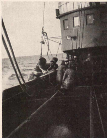
Bild 3. Hieven des Netzes. — Das Grundtau des Netzes wird aufgehievt. Es ist mit großen Holzrollen und Metallkugeln versehen, so daß es selbst über größere Steine weggleitet, ohne daß das Netz zerrissen wird
