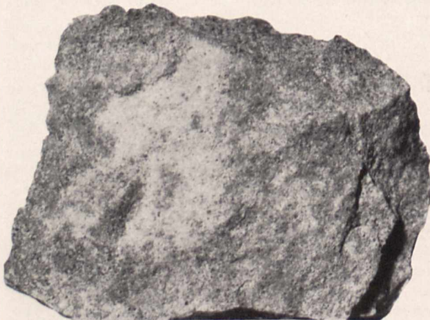
Bild 1. Zementquarzit, gut eingekieseltes Material \frac{3}{4} natürl. Größe
