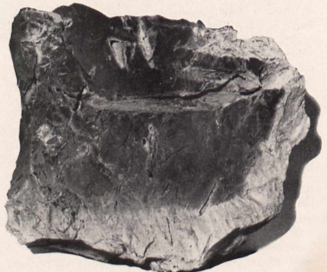
Bild 2. Knollenstein mit Wurzelrohren, die aus der überlagernden Braunkohle in die Quarzitbank hineinragen \frac{1}{2} natürl. Größe
