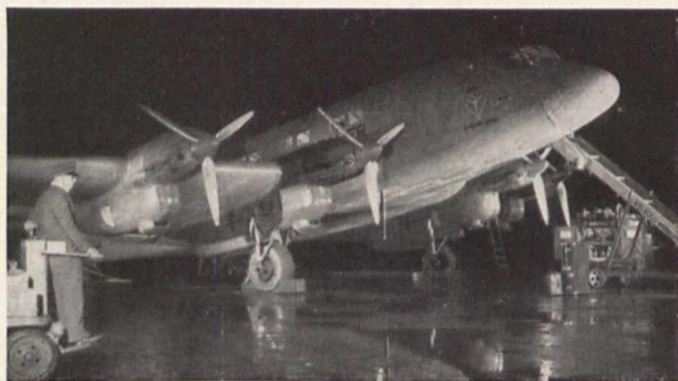
Bild 5. Ju 90 beim Nachtstart. — 4 Motoren von insgesamt 3360 PS, 40 Fluggäste, 4 Mann Besatzung, 325 km/Std. Werkphoto
