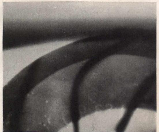
Bild 7. Röntgenblitzlichtaufnahme desselben Gerätes wie Bild 6. Flügelrad in vollem, besonders beschleunigtem Umlauf (6500 U/Min.), belichtet durch 500 synchronisierte Röntgenblitze
