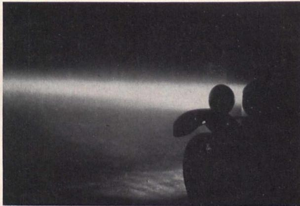
Bild 4. Auch das Ablendlicht wird vom Nebel reflektiert, ehe es den Boden erreicht
