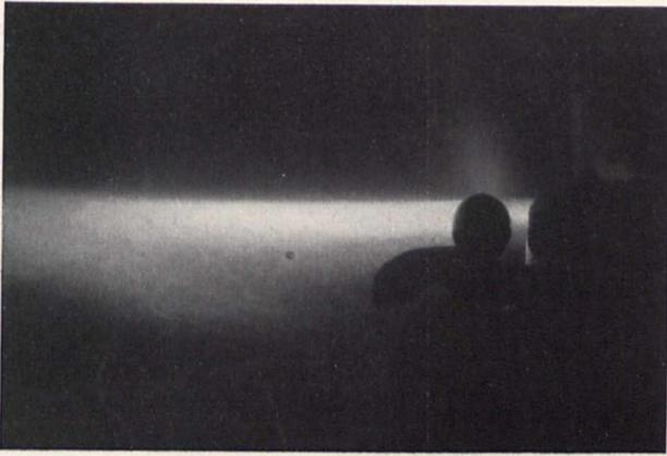
Bild 3. Fernlicht bei Nebel. Das grelle, waagrecht vorausstrahlende Lichtband wird vom Nebel reflektiert
