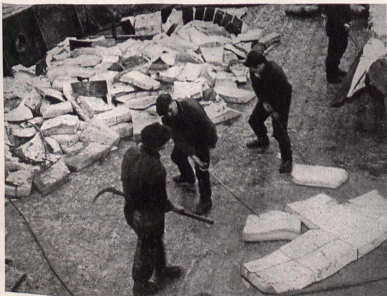
Bild 6. Zerkleinern des Specks zur Beschickung der Speckkocher
